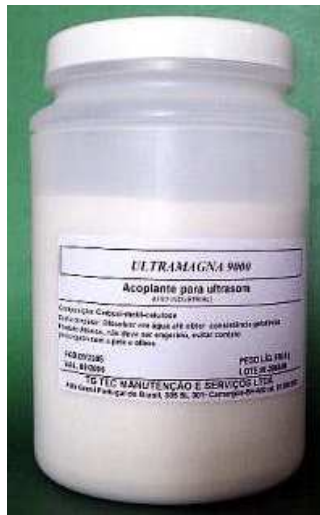
Figura 19 - Gel Acoplante. Neste caso, Metilcelulose. Ideal para materiais não ferrosos.
