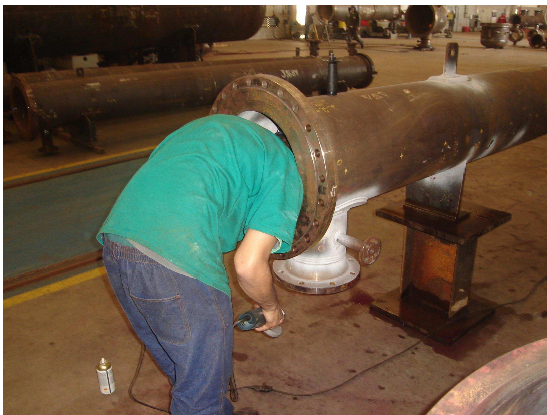
Figura 41 - Inspetor realizando o EN por Líquido Penetrante
