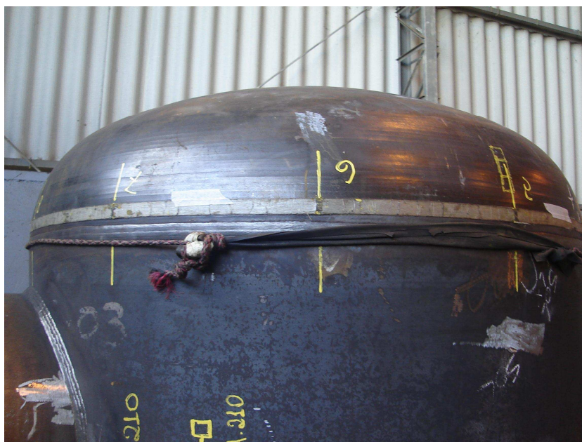
Figura 44 - Solda em tampa ensaiada. As linhas amarelas verticais indicam aonde será colocado o filme radiográfico
