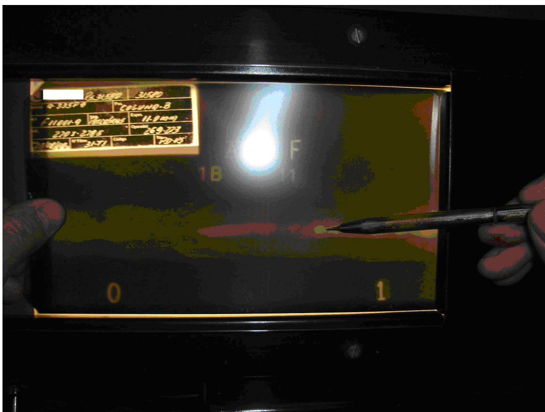
Figura 43 - Ensaio por Radiologia (Indicação de Falha)
